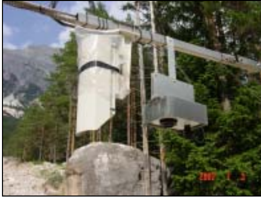
圖 17 設置於 Acquabona 土石流觀測系統之回波計 (左) 與攝影機 (右)，林銘郎攝
