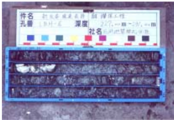
圖 6 斷層破碎帶岩心箱照片(229m 231m)
