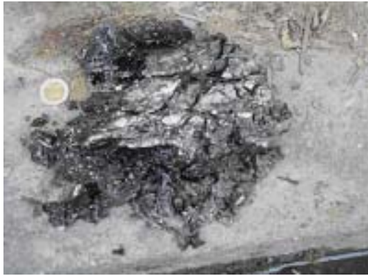
圖 11 熱瀝青與岩塊膠結狀況
